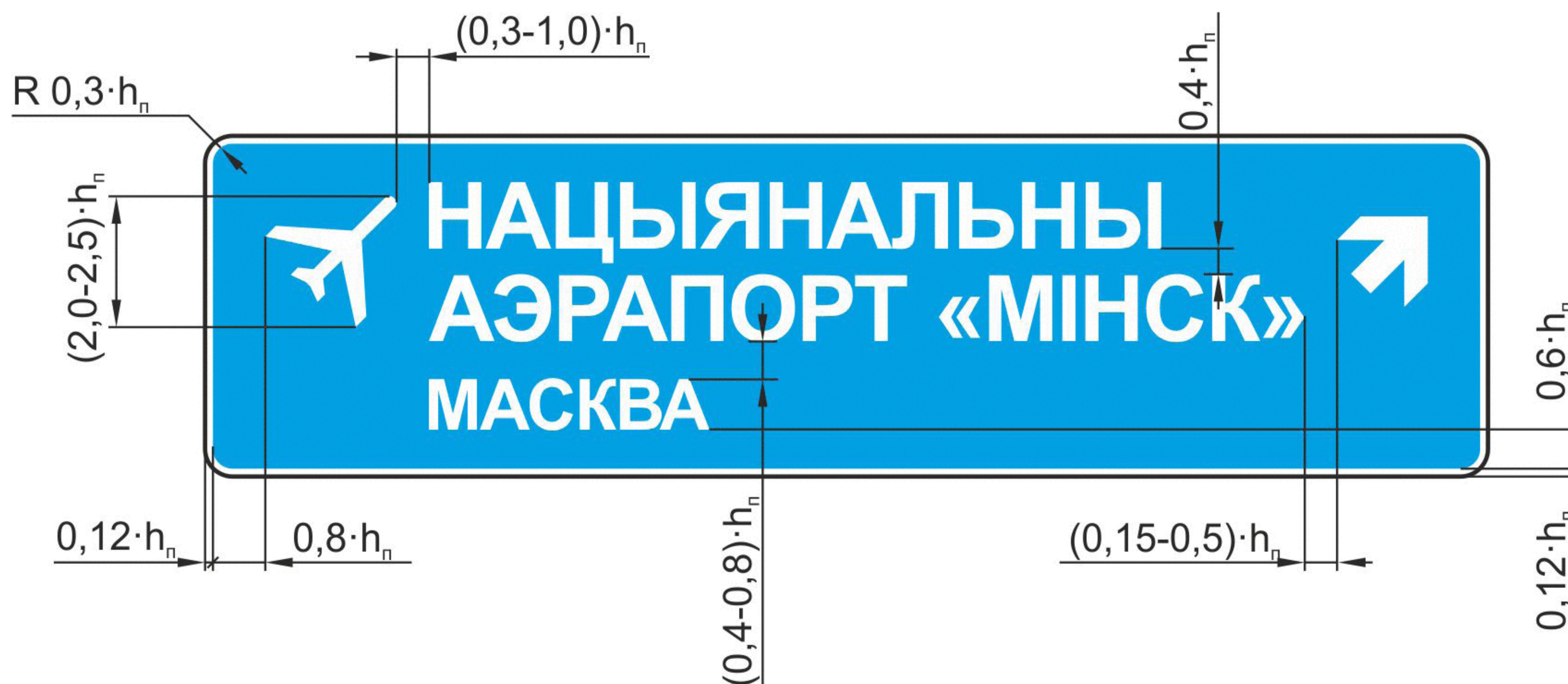
Рисунок В.1 — Пример компоновки изображения знака вида 27
