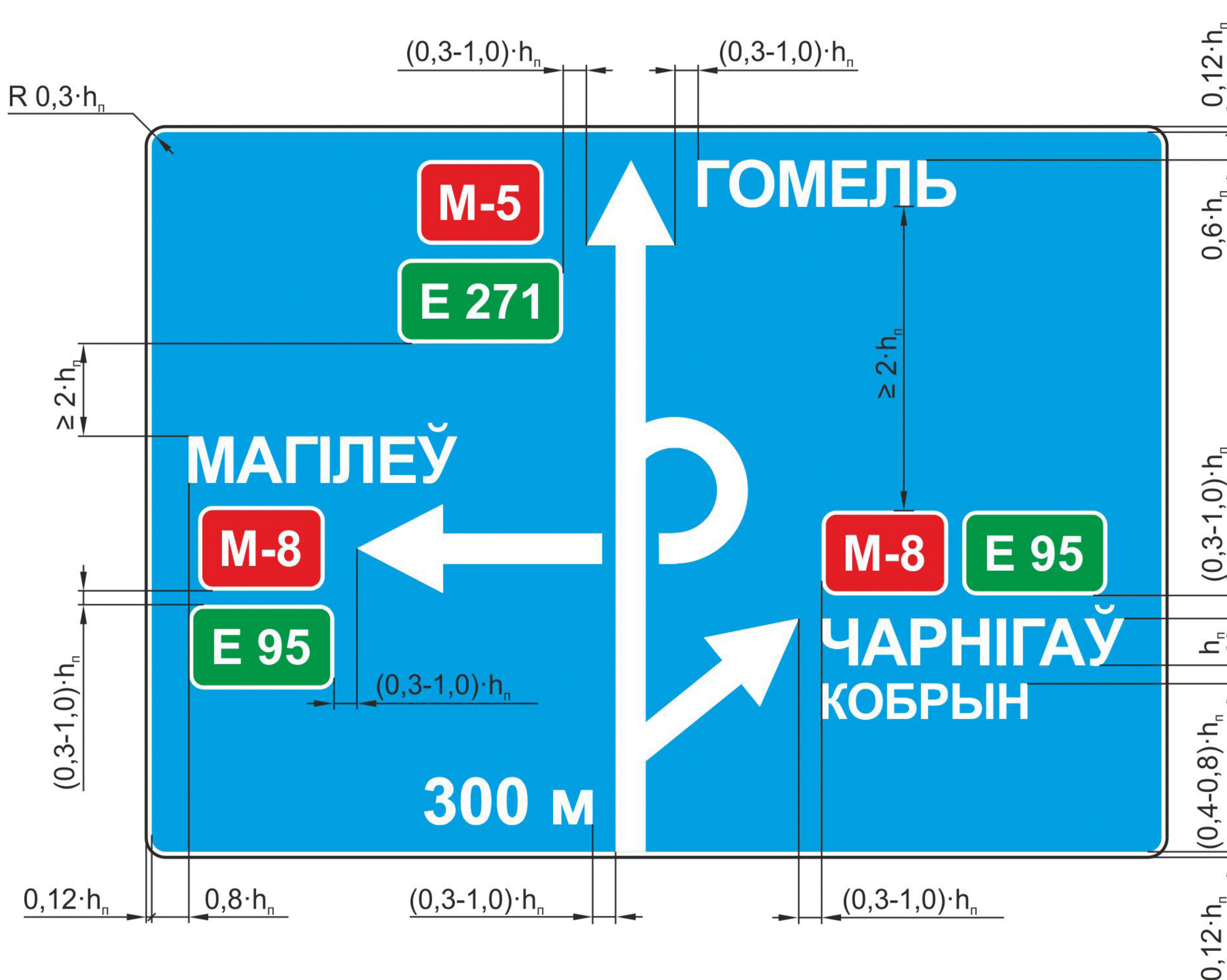
Рисунок В.1 — Пример компоновки изображения знака вида 27
